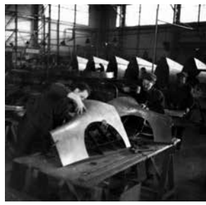
Mise en forme de l'intrados du bord d'attaque de la voilure, au niveau des ouvertures de train d'atterrissage.
