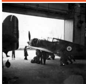
Un avion fini est emmené à l'extérieur pour réaliser les essais moteur.
